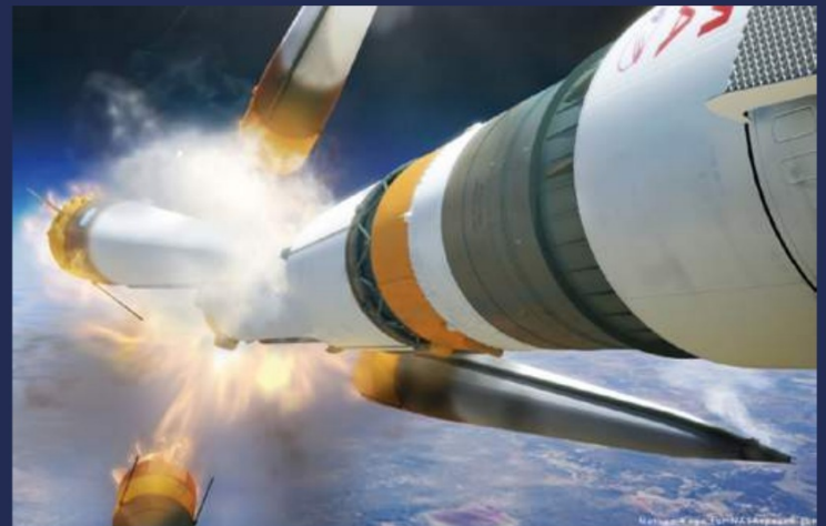
▲ Картина нештатного отделения бокового блока от второй ступени ракеты «Союз-ФГ», составленная по данным телеметрии
