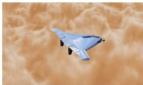
▲ Еще один проект летательного аппарата для исследований Венеры, разрабатываемый в рамках концепции Lifting entry/atmospheric flight (LEAF) . Мини-самолет, построенный по схеме «летающее крыло», сможет парить над облаками планеты на протяжении земного года.
