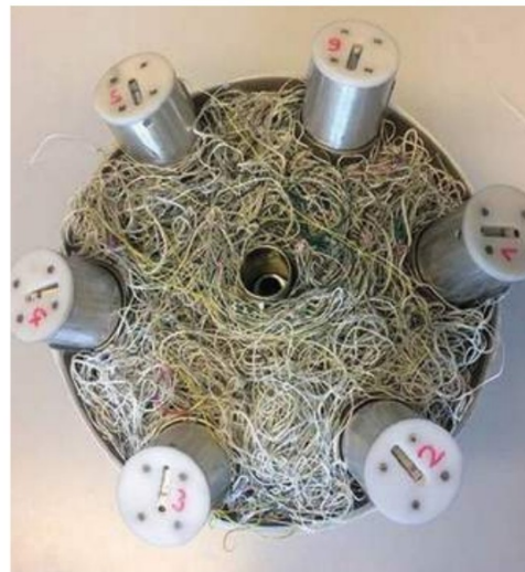
▲ «Космическая сеть» спутника RemoveDebris в специальном контейнере с механизмами для ее развертывания на орбите.
