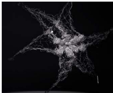
▲ Британский спутник RemoveDebris был выведен на околоземную орбиту высотой около 300 км, где он развернул специальную сеть из прочного тонкого полимерного волокна, предназначенную для «ловли» небольших фрагментов космического мусора. В будущем такие аппараты собираются оборудовать высокочувствительными фотокамерами, а также мощными двигателями, позволяющими им менять орбиту и буксировать захваченные объекты к возможному месту переработки (либо сводить их с орбиты).
