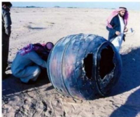
Корпус двигателя третьей ступени ракеты Delta 2, упавшей на территории в Саудовской Аравии
