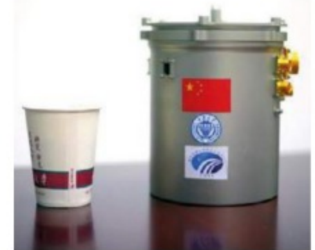
▲ Прототип контейнера для биологических экспериментов, установленного на борту посадочного модуля «Чанъэ-4», в сравнении с бумажным кофейным стаканчиком.
