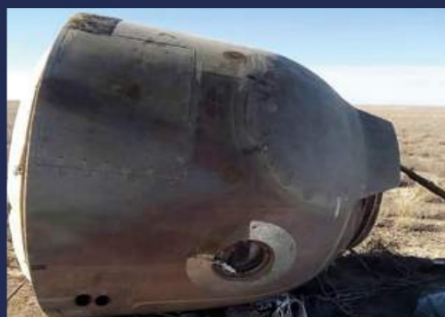
► После отделения от поврежденной второй ступени носителя, приборно-агрегатного и бытового отсека спускаемый аппарат «Союза МС-10» совершил мягкую посадку недалеко от города Жезказган.
